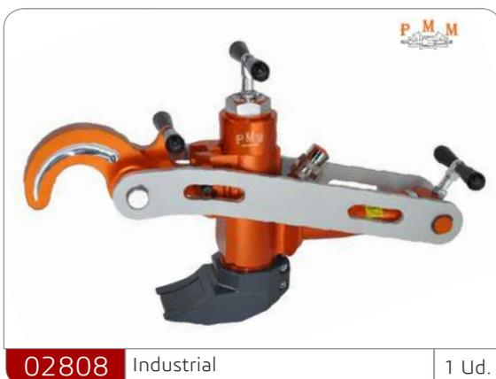
Separa el talón interno y externo de neumáticos de camión tractor y caterpillar de tres piezas hasta 29".
