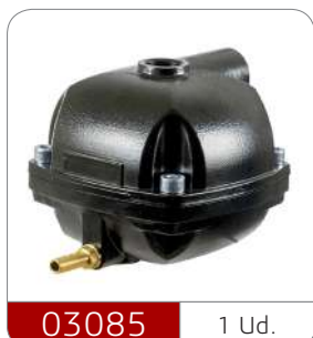
Purga magnética de evacuación de contaminantes PMA 201. Evacuación automática de los contaminantes gracias a una válvula magnética. Entrada rosca hembra BSPP: 2 x G 1/2 salida rosca hembra BSPP: G 1/8 Evacuación de los condensados: 200 l/hora.
