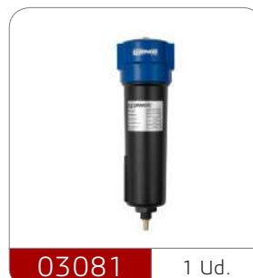
Separador de Agua ciclónico con purga de flotador SPC 235. G 3/4. Caudal 235 m3/h.
